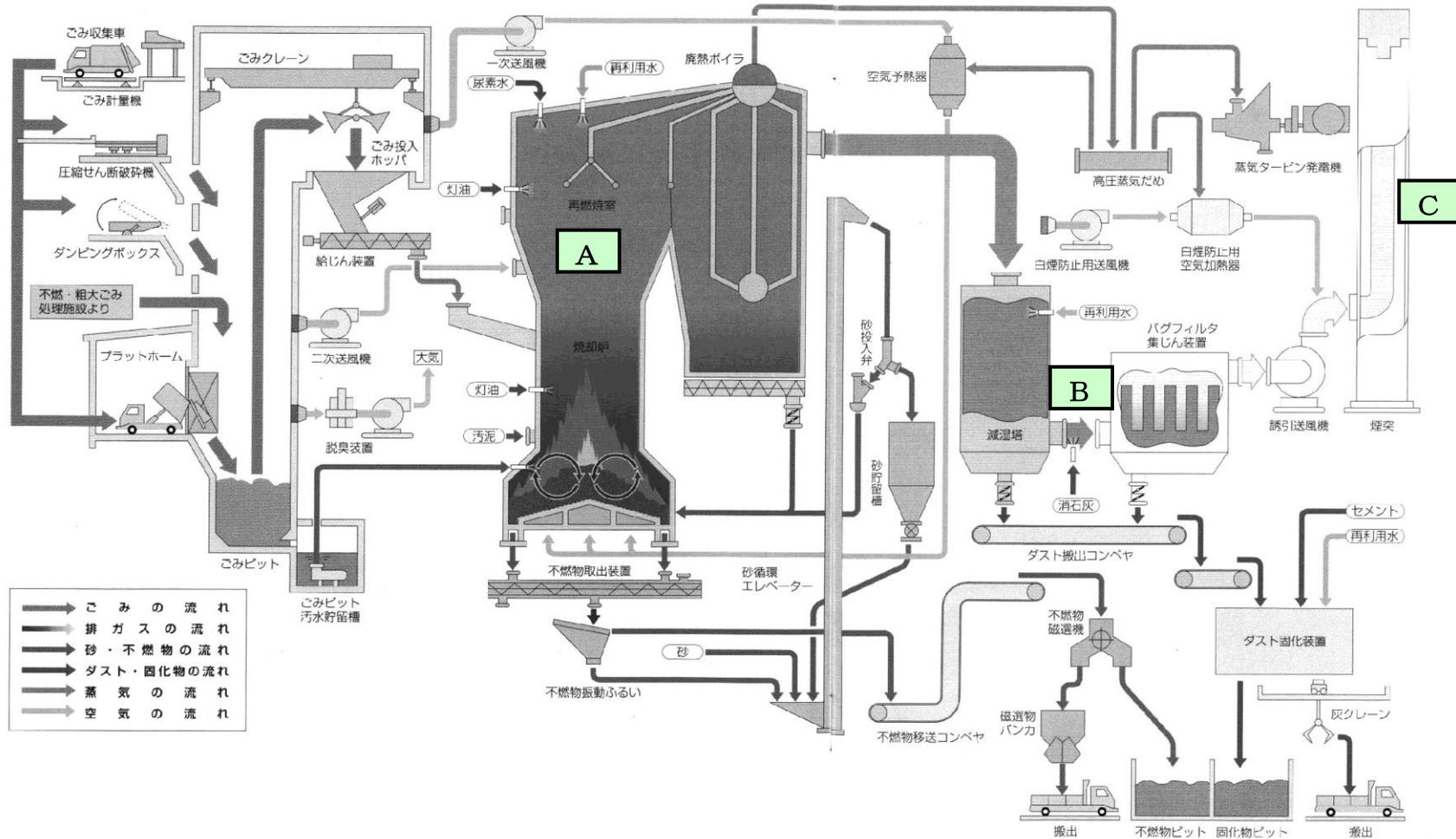
A : 「廃棄物の処理及び清掃に関する法律施行規則」第4条の5第1項第2号トの規定による測定を行った位置 (燃烧ガスの温度)
