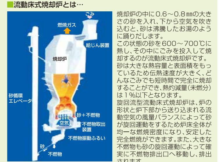
焼却炉の中に0.6~0.8mmの大きな砂を入れ、下から空気を吹き込むと、砂は沸騰したお湯のように踊りだします。この状態の砂を600~700℃に熱し、その中にごみを投入して焼却するのが流動床式焼却炉です。砂は大きな熱容量と表面積をもっているため伝熱速度が大きく、どんなごみでも短時間で完全に燃焼することができ、熱灼減量(未燃分)は1%以下となります。旋回流型流動床式焼却炉は、炉の形状と炉下部から送り込まれる流動空気の風量バランスによって砂が旋回運動をするため炉全体が均一な燃焼密度になり、安定した完全燃焼ができます。また、大きな不燃物も砂の旋回運動によって確実に不燃物排出口へ移動し、排出されます。
